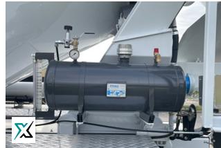
Luftdruck-Zusatzmittel tank (50 L)
