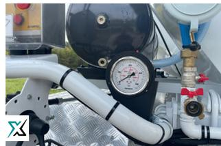
Öldruckmanometer für Betonkonsistenzmessung
