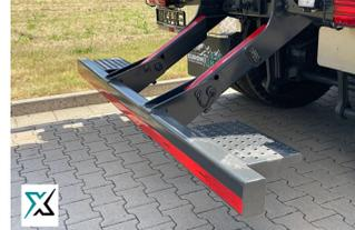
Unterfahrerschutz klappbar mit Tritt
