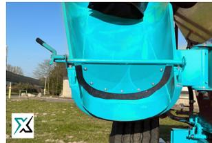
Rückhalteklappe mit Schwenkschurre
