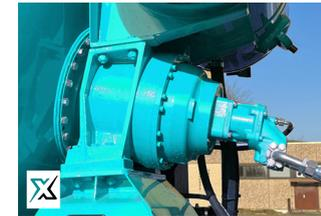
Getriebe, Pumpe u. Motor von
