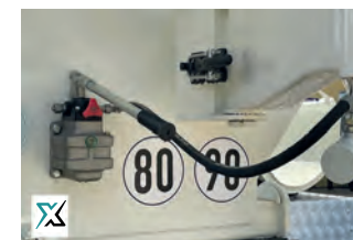
Relevage de goulotte hydraulique
