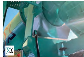
Fermeture complète sous la tremie de chargement
