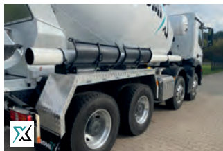
Tuyau en PVC avec support
