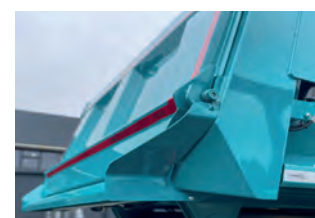
Foyer pour l'asphalte
