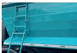
Escaliers de montée vers le pont basculant
