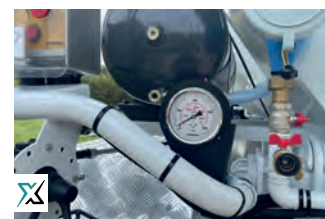
Jauge de pression d'huile pour la mesure de la consistance du béton
