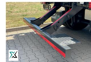
Mechanischer Unterfahrschutz klappbar
