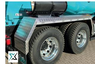
Kotflügel aus Aluminium
