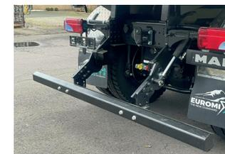
Hydraulischer Unterfahrschutz klappbar
