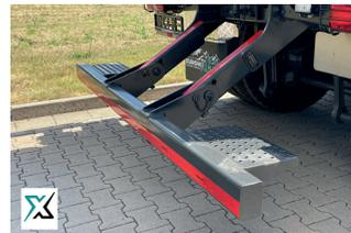
Unterfahrerschutz klappbar mit Tritt
