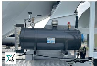
Luftdruck-Zusatzmittel tank (50 L)
