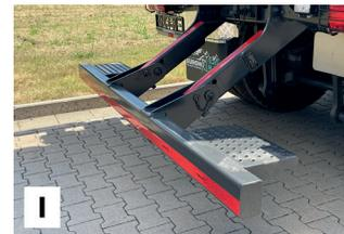
Mechanischer Unterfahrschutz klappbar
