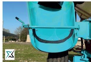
Rückhalteklappe mit Schwenkschurre
