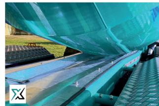
Abdeckung des Fahrgestellrahmens aus Aluminium
