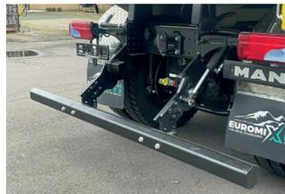
Hydraulischer Unterfahrschutz klappbar
