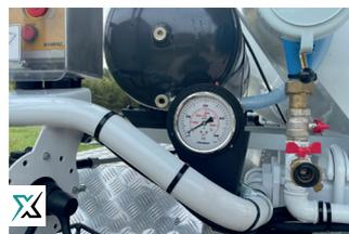
Öldruckmanometer für Betonkonsistenzmessung
